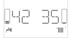
3. Activer le cycle de dégazage en appuyant sur la touche ESC pendant 5 secondes, la chaudière entamera un cycle de dégazage d'environ 7 minutes qui peut être interrompu, si nécessaire en pressant la touche 1, à terme vérifier que l'installation est complètement dégazée, dans le cas contraire répéter l'opération
