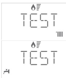
Attendre 1 minute pour que la chaudière se stabilise avant de réaliser les analyses de combustion.
