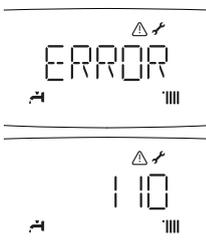
Le premier chiffre du code d'erreur (Ex : 1 01) indique de quel groupe fonctionnel de la chaudière provient le problème
