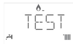
Attendre 1 minute pour que la chaudière se stabilise avant de réaliser les analyses de combustion.
