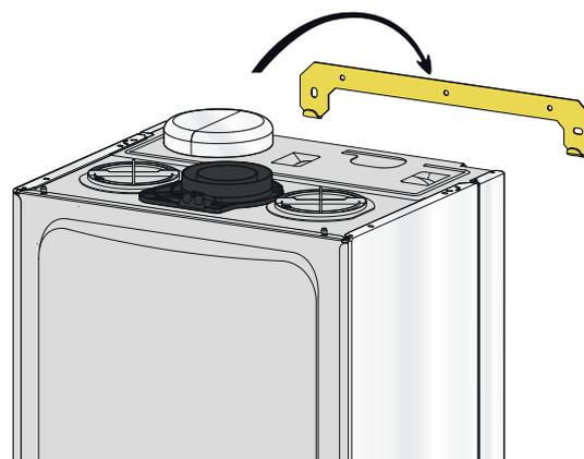
9. déposer la façade de l'appareil (voir page suivante)
