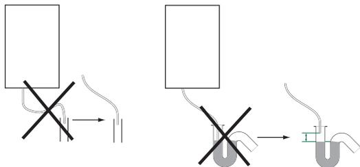
Avant la première mise en route de l'appareil, il est impératif de remplir le siphon de la chaudière avec de l'eau. Le siphon est rempli d'eau pendant l'opération de purge de l'air de l'échangeur principal - voir p. 24
